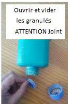
**ATTENTION !** Les granulés d'Oxyde de Fer contenus dans le filtre à soufre doivent être régénérés chaque 100 m3 pour les filtres 1 kg. Vider le filtre et laisser les granulés à l'ombre 24h. On peut ensuite réutiliser les mêmes granulés. Après 4 opérations de régénération il faut mettre des granulés neufs.
